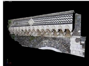
Oggi siamo in possesso dello scanner laser 3D HDS 3000 Cyrax, commercializzato dalla Leica Geosystem. Con questo strumento operiamo nei settori dell'architettura, dell'archeologia, nonché sui beni mobili in genere; ma possiamo anche operare nel settore museale, in quello industriale e per ogni intervento di rilevamento per incidenti di qualsiasi natura: crolli, ipotesi di deformazioni, ecc.
