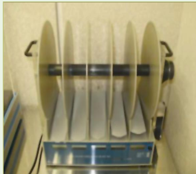
Apparato per il rotarod, necessario per testare le capacità di coordinazione motoria nel topo.
